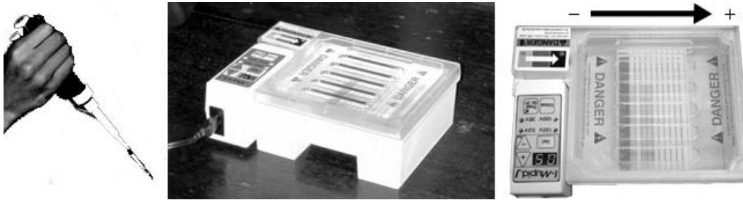
図5.4: 左: ピペッタン(精密ピペット)、中: 電気泳動槽、右: DNAは-極から+極へ移動する
